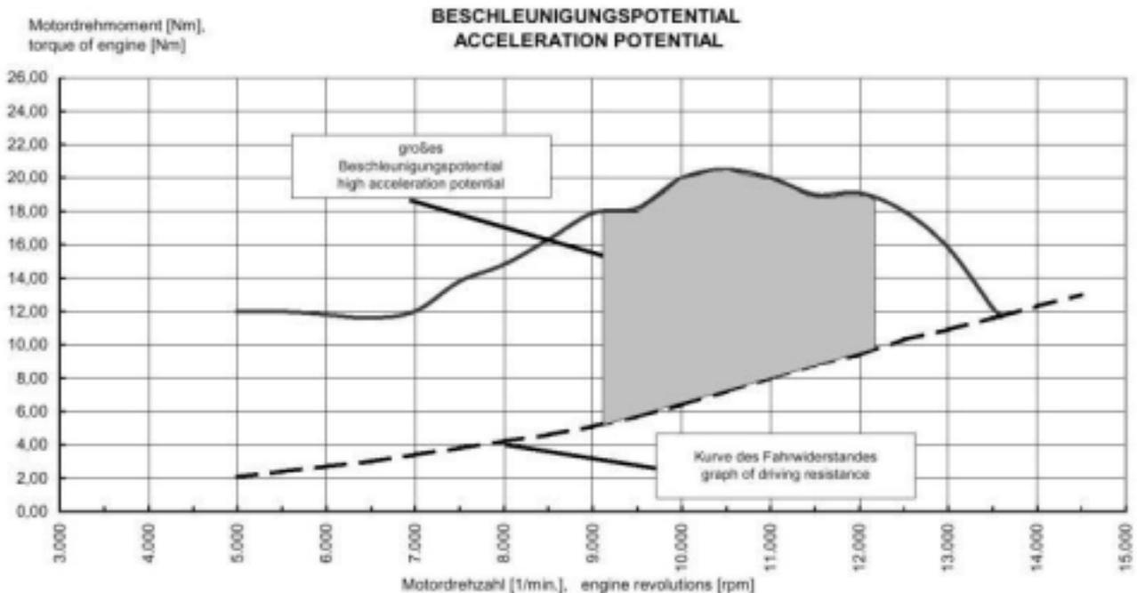
**注釈** : 電気式回転リミッターによって最高回転は、13800回転に制限されています。
