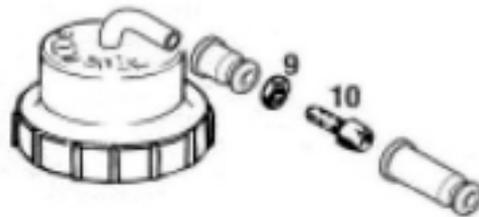
微調整は、キャブレターカバーのアジャストスクリュー (10) とナット (9) を使うようにして下さい。
