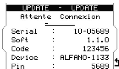
Bluetooth を有効化してディスプレイ上にアイコンを表示させ、Window PC と接続して FIRMWARE をアップデートします。
