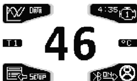
M4/M4GPS に温度センサーが接続されている時は、welcome ページから 10 秒後に自動的に温度 T1 の値が表示されます。
