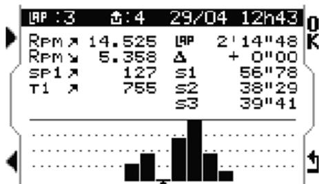
選んだコース、セッションの最初の周を表示します、左上のボタン（矢印が右方向）を使い次のラップに進みます、戻るときは、左下ボタンです。棒グラフの数がラップ数で、棒グラフの高さがタイムを表します、ラップ時間が長いと棒グラフが高くなります。
