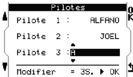
3 人のドライバーを設定できます。選択したドライバーは、測定時にデータと結びつけられます。
