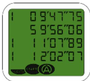
さらにボタン「A」を押すと「START」ポジションに戻り、計測ができます。
