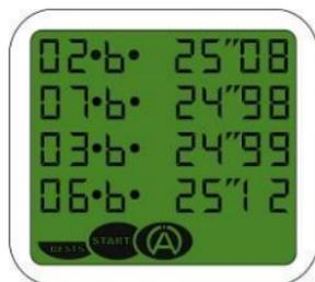
ボタン« A »を1度押すとベストLAPが表示され、2度押すと最終LAPが表示されます。それぞれ2秒間表示され、その後は通常の計測画面に戻ります。
