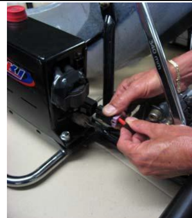
19.ケーブルをバッテリーボックスに接続します、接続がシッカリされているか確認して下さい
