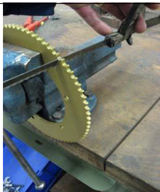
7. スプロケットは正しい位置でカットして下さい (2つの歯の間、取付穴にかからない位置)
