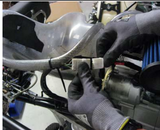
20. ケーブルをエンジンケーブルに接続します、接続がシッカリされているか確認して下さい
