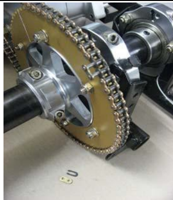
12.リンク付のチェーンか、チェーンカッター を使用してチェーンを取付けます
