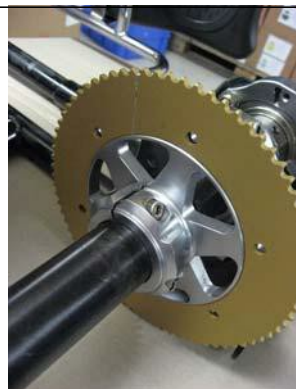
8. スプロケットをハブに6個全ての穴を使って取付けて下さい
