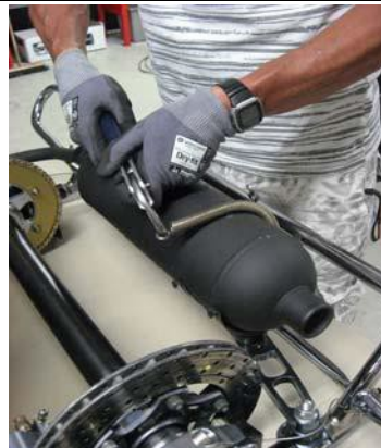
18.サポートにサイレンサーエンドをバネで固定します
