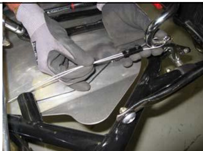
25.ペダルストッパーを考慮してスロットルケーブルをペダルに取付けて下さい
