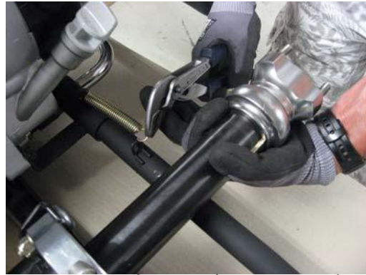
16.テールパイプとエキゾーストパイプをバネで接続します
