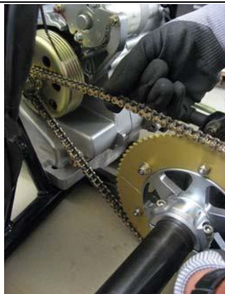
13.マウントクランプを締付けたときのこと を考慮してチェーンの張りを調整します、ク ランプを締付けたときに上下に1cmの遊び が必要です
