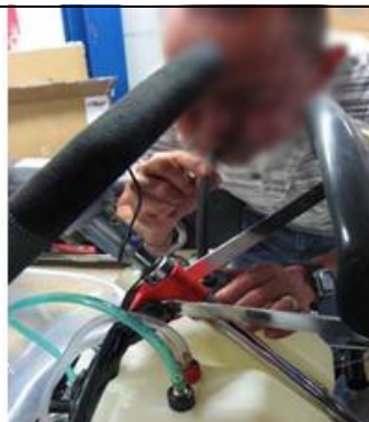
26.タンクに空気を吹き込んで燃料ホースに燃料を行き渡らせて下さい
