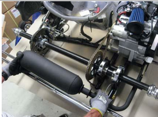
17.サイレンサーエンドをテールパイプに取付けます、サイレンサーエンドがサポートにしっかり取付けられるか確認して下さい
